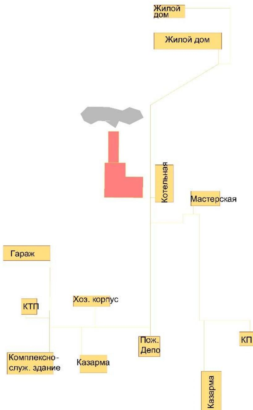
Рис. 3.7. Схема тепловой сети котельной «Воспушка в/ч»
