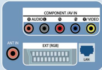
↑ Разъем для подключения антенны на цифровом телевизоре
